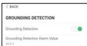
Figura 7-20 Detecção de aterramento
